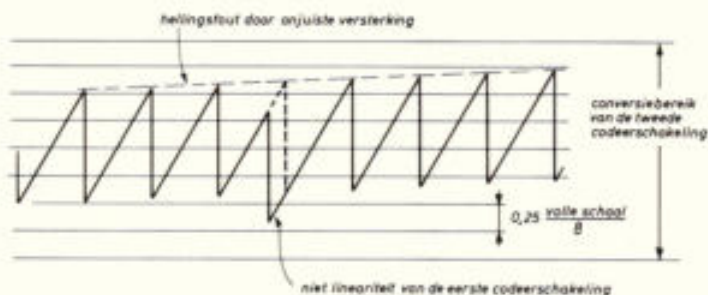
Fig. 7. Restsignaal aan de ingang van de tweede codeerschakeling van een DCS-omzetter. Merk op dat door het vergroten van het scheidend vermogen met één bit van de eerste codeerschakeling, de tweede converter in staat is het signaal te blijven volgen; hoewel versterking en niet-lineariteitsfouten dezelfde zijn als die in fig. 6. Dientengevolge gaat er geen signaal informatie verloren en kan de digitale correctie de juiste digitale uitgangscodes leveren.
